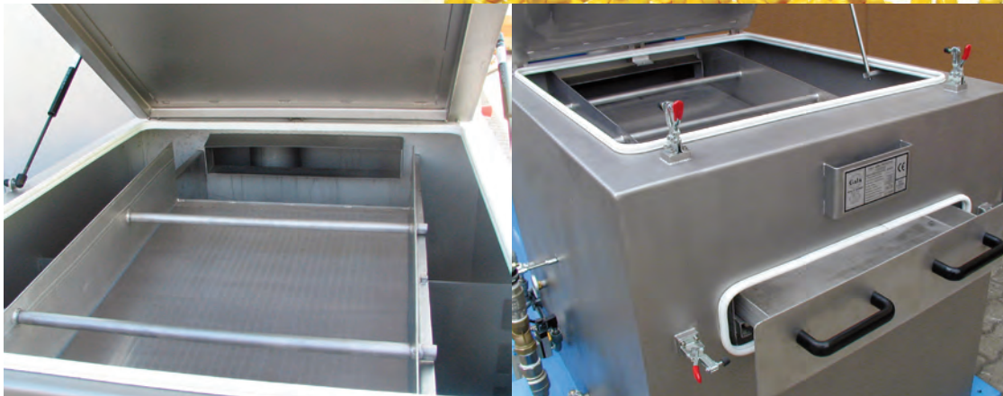
Wassertank mit (IS) integriertem Sieb zur Entfernung von Feinteilen bis zu 300 µm.
